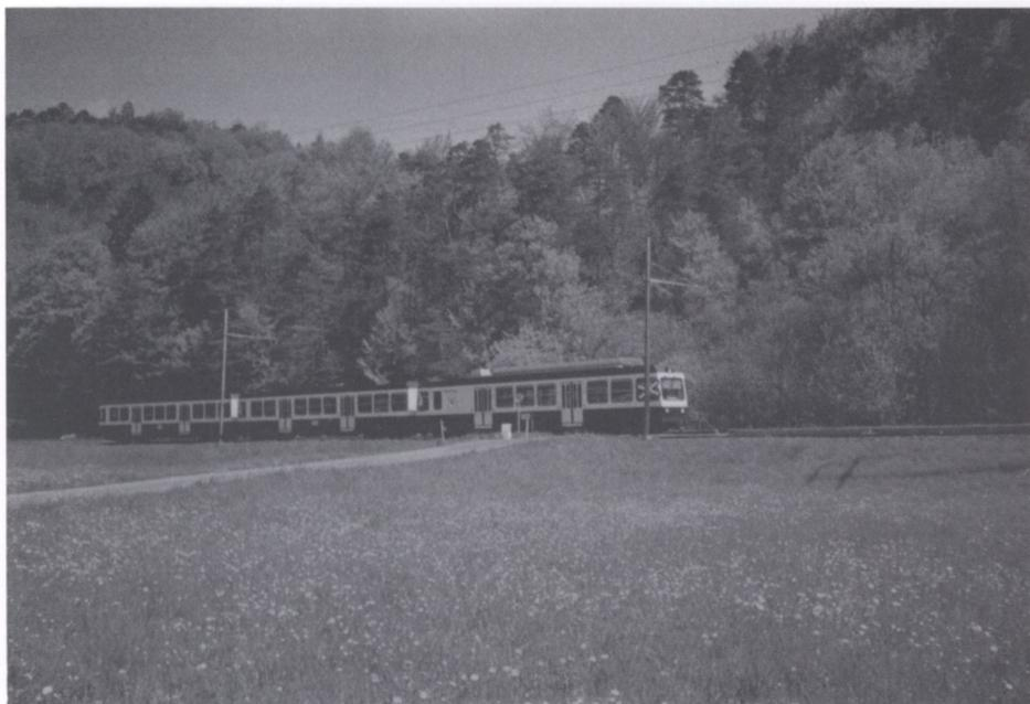
Waldenburgerbahn (WB) in der für die Schweiz einmaligen Spurweite von 750 mm. Die rund 14 km lange Strecke verlief anfangs grösstenteils am Rande der Hauptstrasse, von Liestal bis Altmarkt mittels Vierschienengleis zwischen den Gleisen der Centralbahn.
