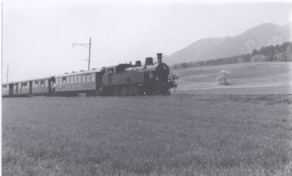
Da der Verkehr auf der 23 km langen Strecke Solothurn-Moutier um die Jahrhundertwende stetig zunahm, wurde die Beschaffung einer neuen leistungsfähigen Dampflok notwendig. Die Anforderungen waren wie folgt: ein 250t Zug musste bei einer Steigung von 25-28‰ mit 18-20 km/h gezogen werden können. Man einigte sich schliesslich auf eine Vierkuppler-Güterzug-Tenderlokomotive mit voranlaufender Laufachse, so dass auch ein Einsatz im
